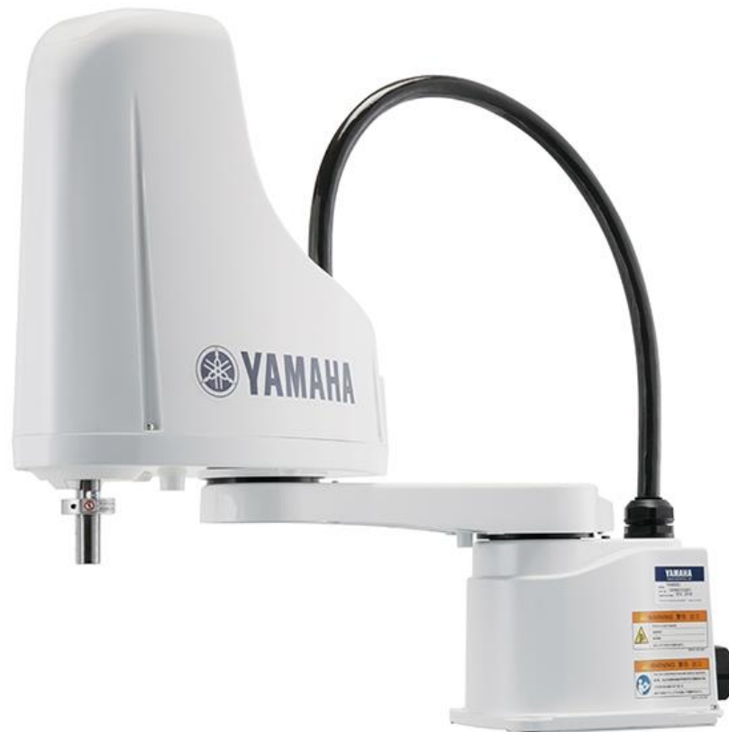
Hình 14. Hình ảnh robot scara của công ty
